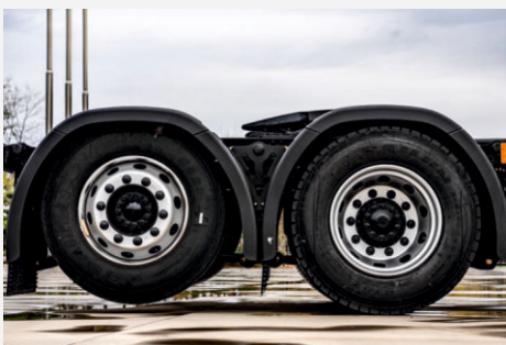
- Односкатная ошиновка 3-й (подъемной) оси
